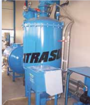
Automatic mixing vessel for resin and fillers Mélange résine et charge en automatique
