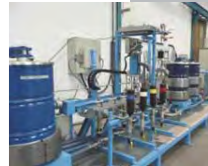
Remote-controlled pump changing operation Changement de matière première à distance
