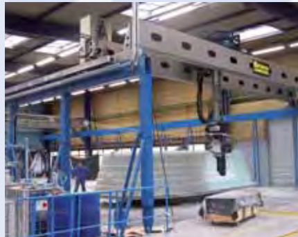
Simultaneous spray-up of resin and fiberglass (12 kg - 26 lbs of laminate/min) Projection simultanée résine et fibres de verre (12 kg stratifié/min)
