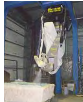
Robotic spray-up of resin and fiberglass Projection simultanée résine et fibres de verre
