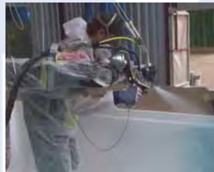
Resin and fiberglass spray-up programming phase Programmation de la projection simultanée résine et fibres de verre
