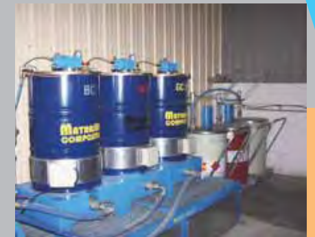
Continuous raw material supply system for the robot Alimentation en continu du robot en matière première
