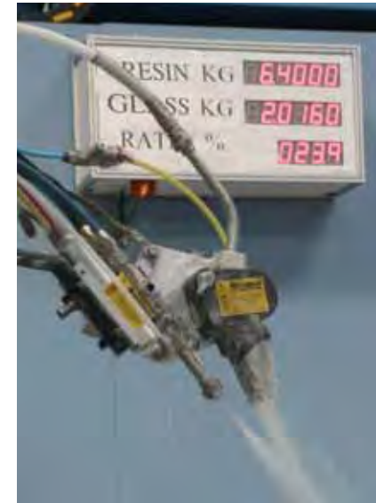
Spraying quantity control Contrôle des quantités projetées
