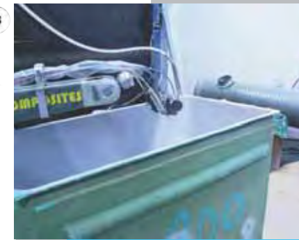
Simultaneous spray-up of filled resin and fiberglass on female mould Projection simultanée résine chargée et fibres de verre en moule femelle
