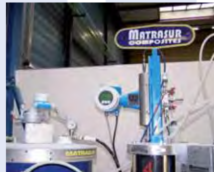
Catalyst flow rate control Contrôle du débit catalyseur
