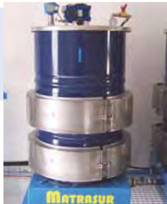
Buffer drum for resin Fût tampon pour la résine
