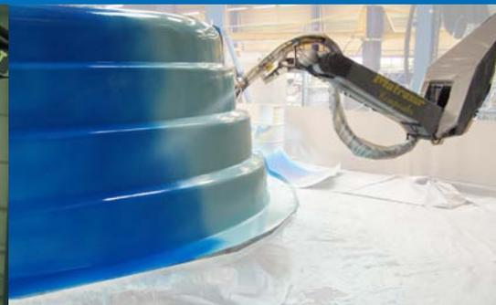
Projection de barrier coat sur paroi verticale
